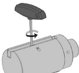
Klemmbalken spannen Fix the clamping wedge
