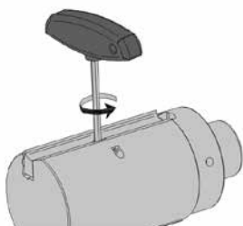
Klemmbalken spannen Fix the clamping wedge
