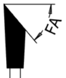
Fasenwinkel FA chamfer angle FA
