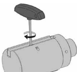
Klemmbalken lösen Release the clamping wedge
