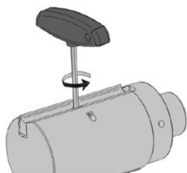
Klemmbalken spannen Fix the clamping wedge
