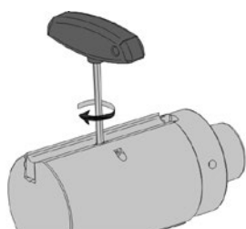
Klemmbalken lösen Release the clamping wedge
